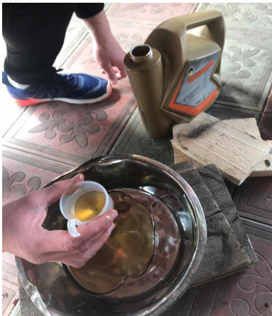
Рисунок 2 – Определение вязкости масла после обработки ультразвуком
