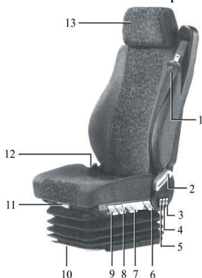
Рисунок 4 – Конструктивные особенности сиденья водителя КАМАЗ 5490
