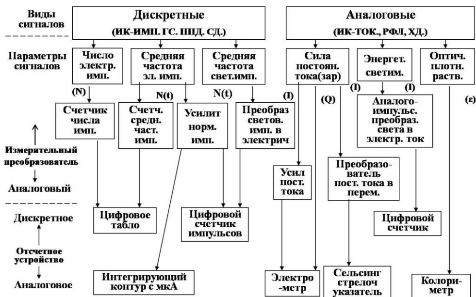
Рисунок 1 – Классификация детекторов, измерительных преобразователей и отсчетных устройств, применяемых в дозиметрической аппаратуре
