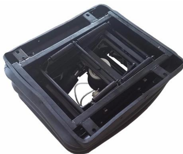
Рисунок 2 – Пневматическая подвеска сиденья грузового автомобиля
