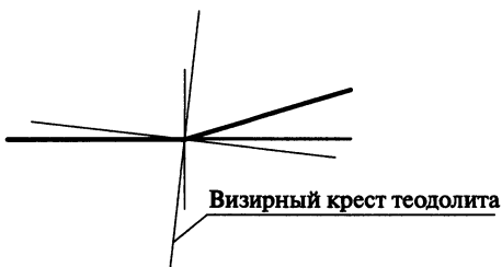
Рис. ЛР11.6. Определение погрешности установки оптической системы прибора в горизонтальной плоскости
