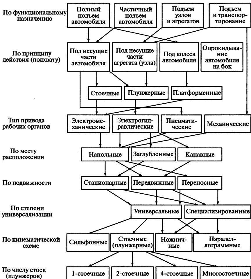
Рис. 5.8. Классификация подъемно-осмотрового оборудования
