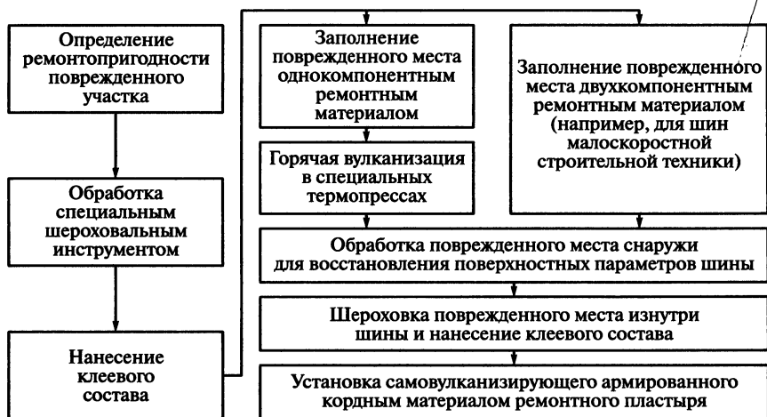
Рис. 6.8. Основные этапы ремонта сквозных повреждений шин
