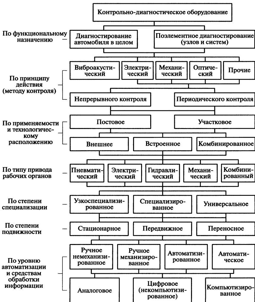
Рис. 5.18. Классификация контрольно-диагностического оборудования
