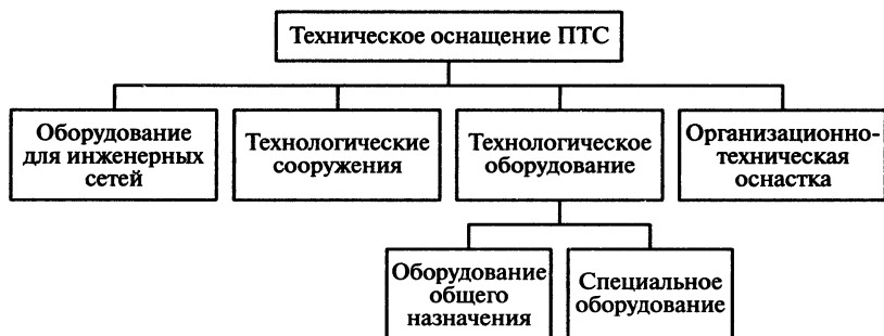
Рис. 5.1. Состав оборудования, используемого на ПТС
